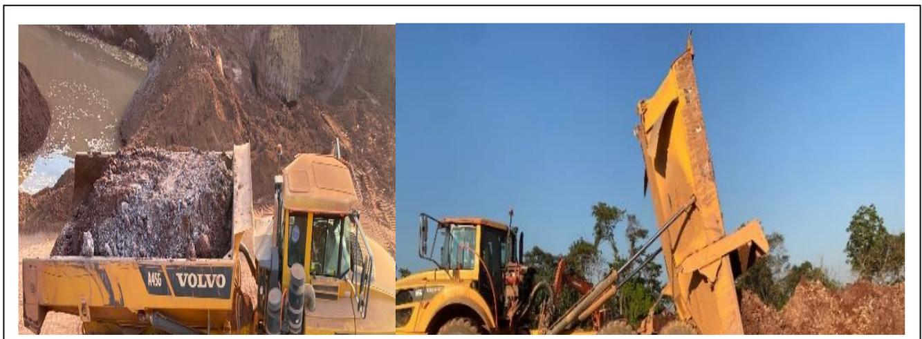
**Figura 3. 10:**Processo de transporte e deposição do Minério na Lavaria
