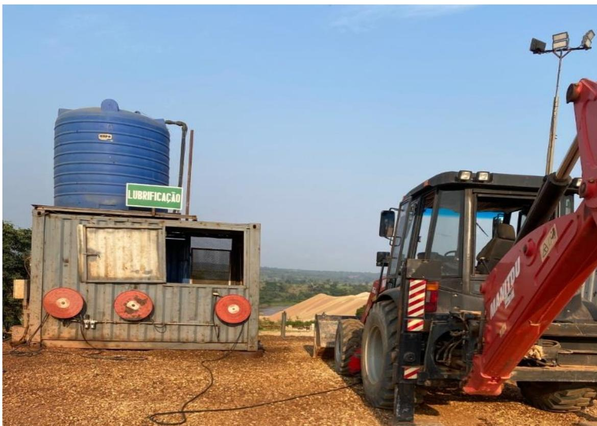
**Figura 3. 17:**secção de lubrificação e estação de serviço
